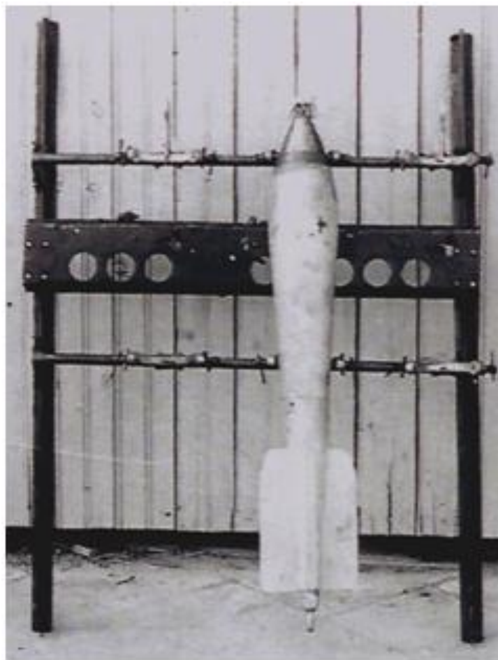
.Bomba “Hispania” Mod. A.5 presentada en un lanzabombas horizontal 3-A-5
