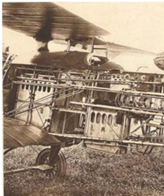
(Izda.) Breguet XIX B 2, de bombardeo, mostrando los lanzabombas pequeño, para 12 bombas de 10/14 kg. (A) y grande para 32 bombas de 12/14 kg. u/ 8 de 50/54 (B). (Dcha.) Breguet XIX A2, de reconocimiento; se aprecia el lanzabombas pequeño (A) y el compartimento para la cámara fotográfica (B) en sustitución del lanzabombas grande.
